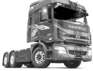
loppant des puissances allant de 270 ch (862 Nm) à 420 ch (1833 Nm) et couplés à des boites de vitesses (manuelles et automatiques) ZF ou Eaton de 9 à 12 rapports.
